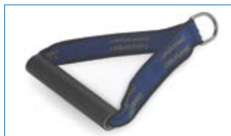
AC0298 MANIGLIA 2 Maniglia con presa in gomma antiscivolo di diametro 30 mm, con anello cromato per aggancio di diametro 35 mm. È Utilizzabile solo con accessorio AC0094 – MOSCHETTONE. (pezzo singolo) Dimensioni: cm 22 x 16 x ø 3 Peso: gr 100
